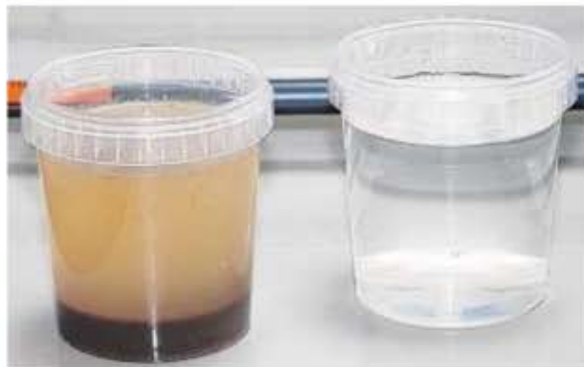
In Stufen: Nach der ersten Reinigungsstufe sieht das Abwasser bei Bostik (links) noch trüb aus. Große Mengen der Kleberreste sind allerdings schon gebunden und haben sich am Boden des Gefäßes abgesetzt. Nach der zweiten Reinigungsstufe (links) ist das Wasser klar und fließt in die öffentliche Kanalisation.
